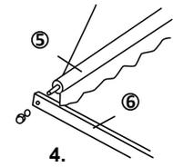
Fig 4 Connectez la barre d'angle (pièce n°6, gauche et droite) à l'extrémité de la barre frontale (pièce n°5). Recommencez cette action pour connecter l'autre côté.
