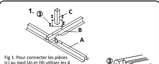
Fig 1. Pour connecter les pièces (c) au pied (A) et (B) utilisez les 4 boulons M10x20 (4). Voir le schéma pour la fixation des pieds.
