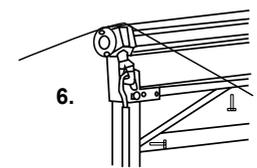
Fig 6 Utilisez le boulons M8 -50 mm et M8 - 35 mm pour installer les barres inclinées des deux côtés. L'assemblage est maintenant terminé, et le store est prêt à être utilisé.
