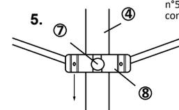
Fig 5 Pour ajuster le bras d'angle et de hauteur (n°6), desserrez la vis (pièce n°7). Utilisez le remontoir pour dérouler le tissu (la barre d'ajustement (pièce n°8) bougera en fonction). Une fois la hauteur réglée, resserrez la vis (pièce n°7).
