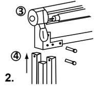
Fig 2. Insérez l'enrouleur (pièce n°3) en haut du montant (pièce du milieu, pièce n°4). Connectez les deux pièces en utilisant les boulons M8 - 60 mm. Recommencez cette action afin de connecter l'autre côté.
