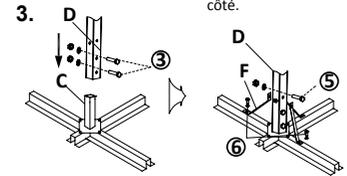
Fig 3 Deux personnes seront nécessaires pour réaliser cette étape. Connectez les sections du milieu (n°4) avec les pieds (gauche et droite) en utilisant les boulons M8 - 50 mm, puis vissez les bras de soutien avec les boulons M8x60mm (5) et M8x60mm (6) comme indiqué.
